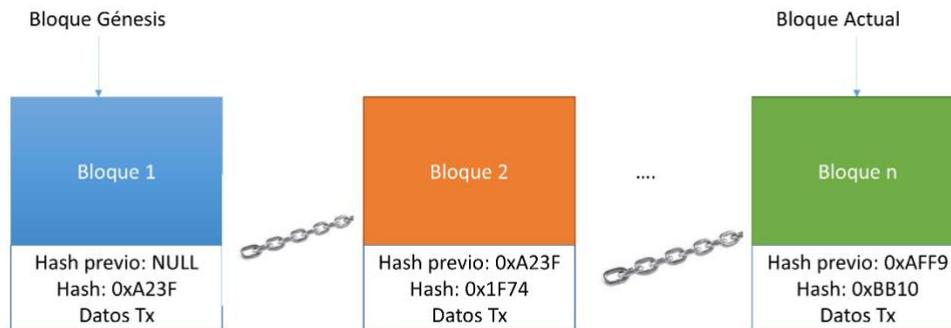
**Figura 2-11** Estructura de datos general básica de una cadena de bloques.
